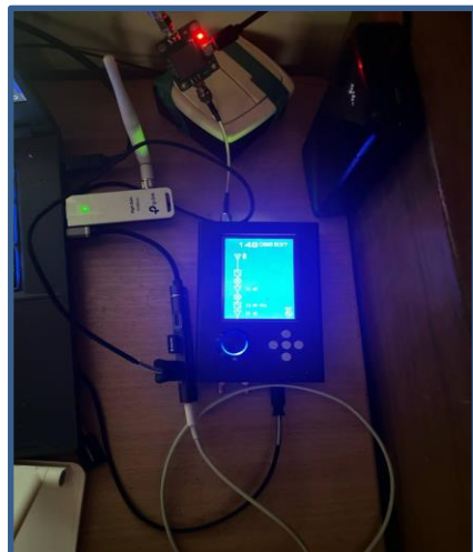
СДР-приемник ХАК-РФ с антенной
