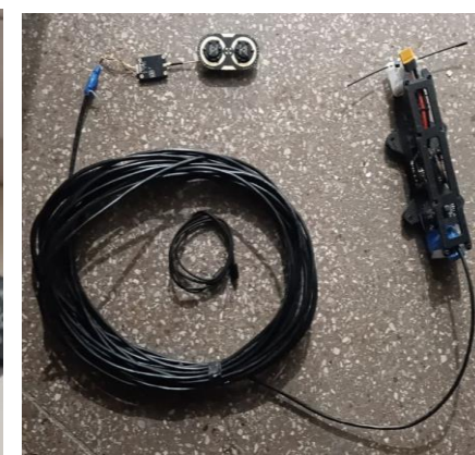
Видеопредатчик 2,5 Вт на выносе
