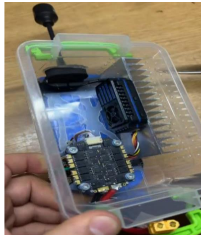
Видеопредатчик 5 Вт в контейнере
