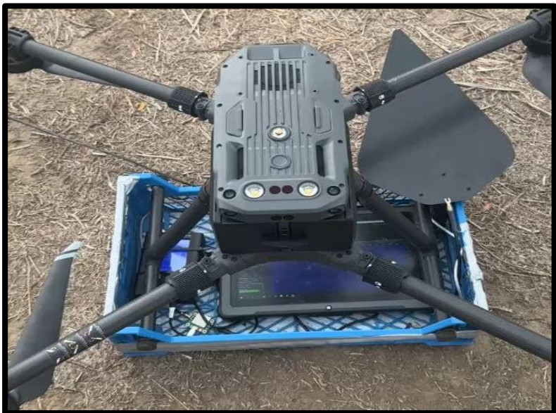
БПЛА Матрикс 300 РТК с аппаратурой радиоразведки
